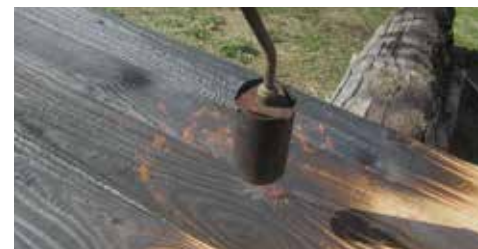
Test de « bois brûlé » avec du Douglas du Morvan © Atelier Correia
